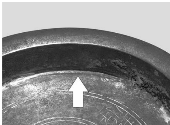
図15. 断面V字形の削りこみ（部分拡大）
