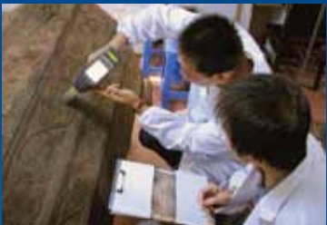
日中の技術者による共同作業。最新の蛍光X線分析装置で彩色の顔料を分析、記録
