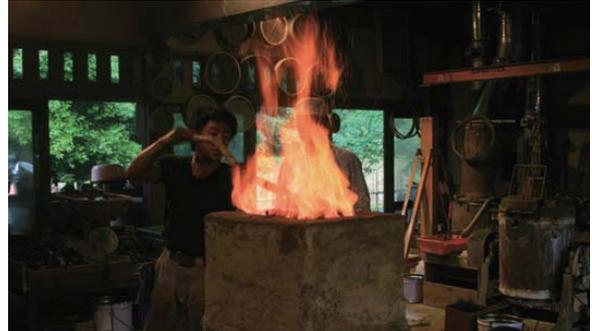
砂鉄を始発原料とした製鉄炉の操業実験 (福岡県芦屋釜の里)
