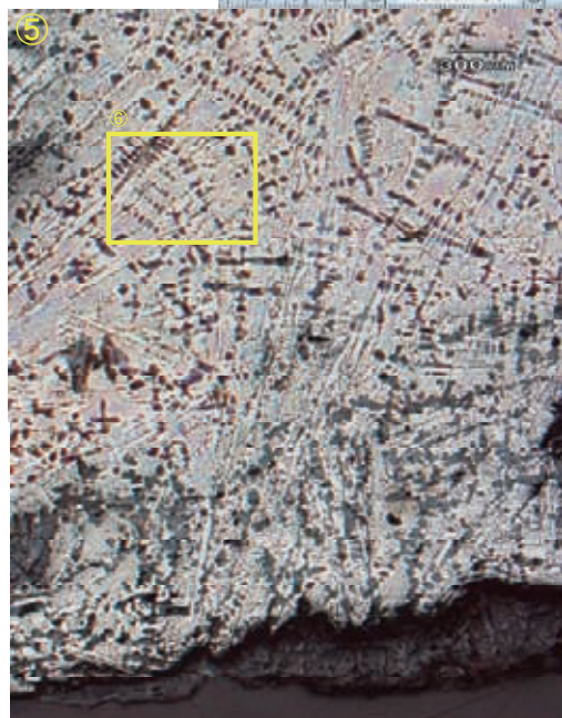
Fig.43 羽口・鑄鉄塊の顕微鏡組織
