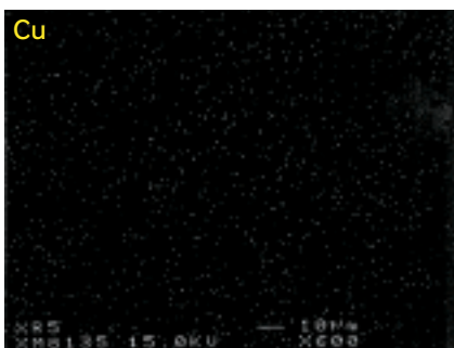
Photo.6 梘形鍛冶滓の顕微鏡組織・EPMA調査成果
