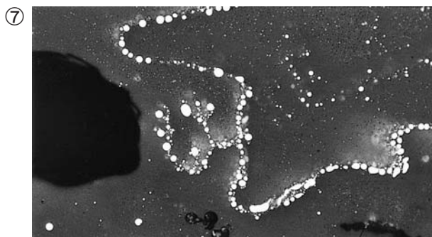
Photo.7 鑄造鉄器片・取鍋の顕微鏡組織
