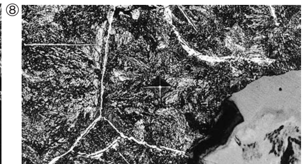
Photo.1 梔形鍛冶滓・鉄塊系遺物の顕微鏡組織
