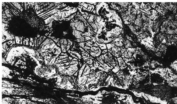
Photo.8 椀形鍛冶滓・鉄塊系遺物の顕微鏡組織
