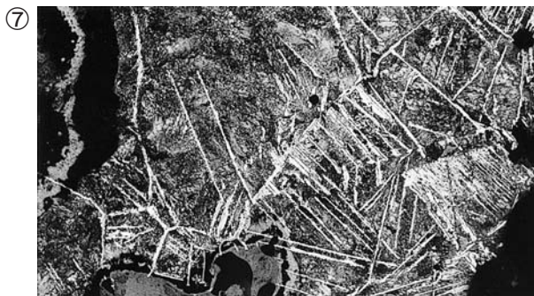
Photo.1 梔形鍛冶滓・鉄塊系遺物の顕微鏡組織
