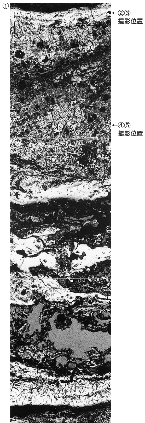
Photo.2 鑄造鉄器片の顕微鏡組織
