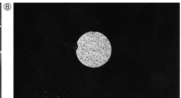
Photo.7 鑄造鉄器片・取鍋の顕微鏡組織
