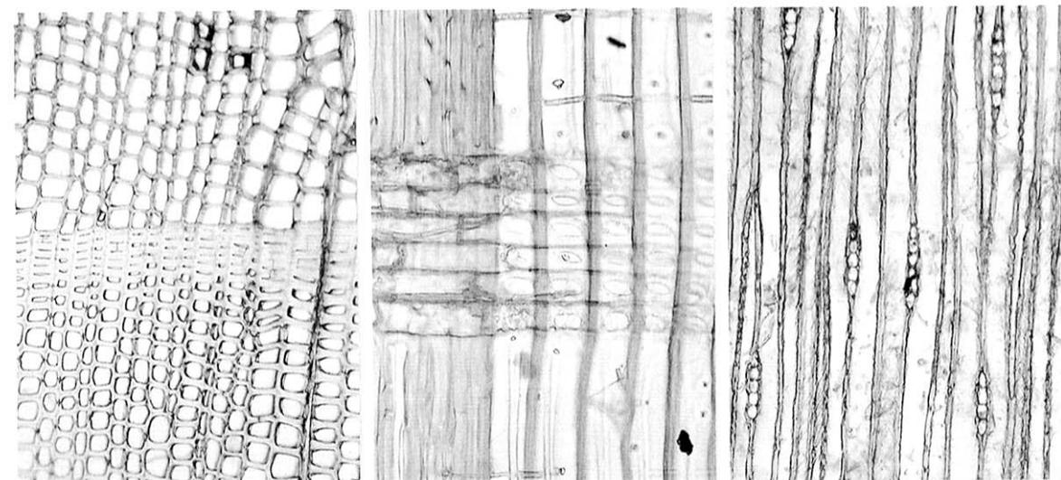
横断面 ————— : 0.2mm    放射断面 ————— : 0.1mm    接線断面 ————— : 0.2mm
