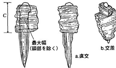
Fig.36 鉄製釘観察模式図
